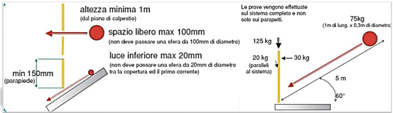
Figure 28: Parapetto di classe C
